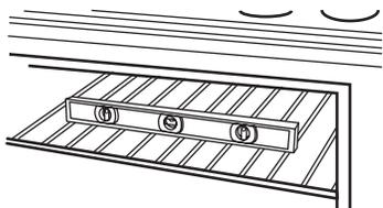
3. Si la cuisinière n'est pas d'aplomb, ajuster les tiges de nivellement. À l'aide d'une clé, tourner les tiges de nivellement situées derrière la plinthe pour mettre la cuisinière d'aplomb et pour soulever ou abaisser la cuisinière à la hauteur de plan de travail désirée. Les tiges de nivellement peuvent être placées jusqu'à 1 1/2 po (3,9 cm).
