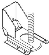
2. Déplacer la cuisinière dans son emplacement final en s'assurant que le pied de nivellement arrière glisse dans la bride antibasculement.
